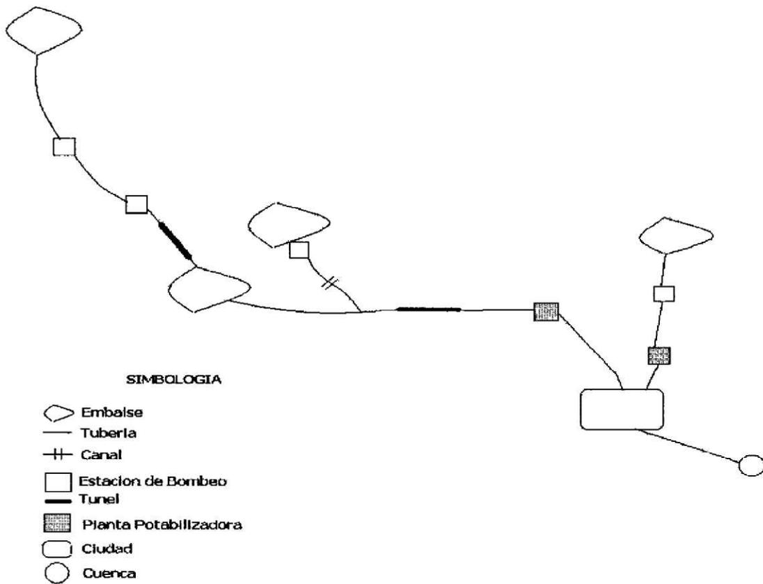
Figura 3. Esquema de Distribución del Sistema de Abasto de Agua .
