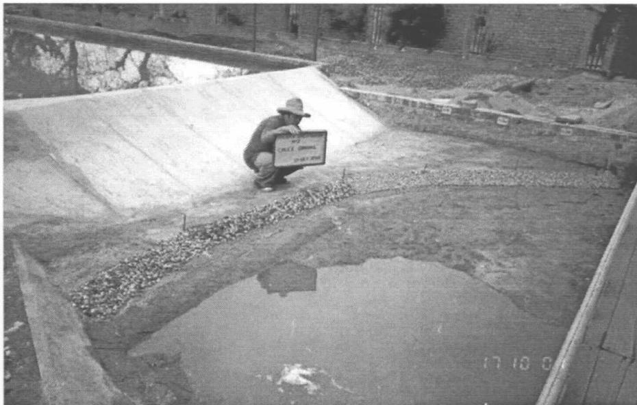
Foto 4.0: Ensayo de Investigación N°2. Disposición del enrocado al iniciar el ensayo. La modificación incorporada fue en el peso del enrocado entre las estacas A y C ( $W = 0.8 - 4 \text{ Ton}$  ;  $D = 0.70 \text{ a } 1.50 \text{ m}$  )
