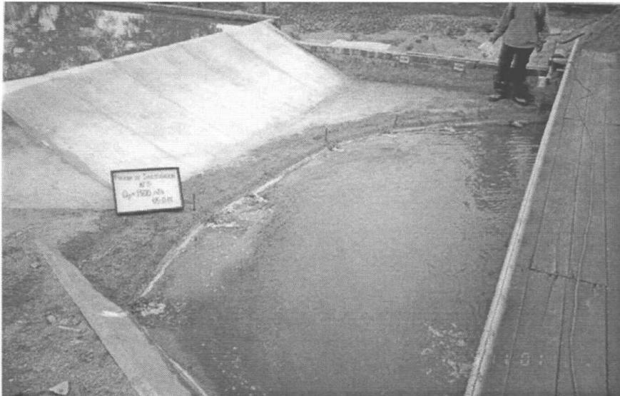
Foto 6.0 Ensayo de Investigación N° 5. Estudió del patrón de flujo con  $Q = 1500 \text{ m}^3/\text{s}$  en la margen izquierda del cuenco la cual fue protegida con un sistema de espigones.
