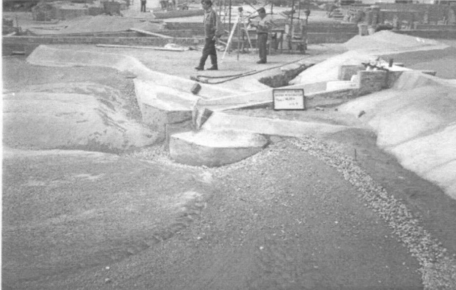
Foto 5.0: Ensayo de Investigación N°2. Detalle del comportamiento del enrocado de la margen izquierda con  $Q = 4000 \text{ m}^3/\text{s}$  del hidrograma, en etapa decreciente.
