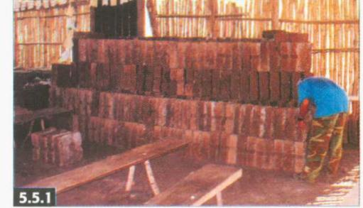
Después de 15 días de secado, mover y Apilar los adobes de canto para que no se quiebren y almacenarlos en bodega ventilada y protegida de la intemperie.
