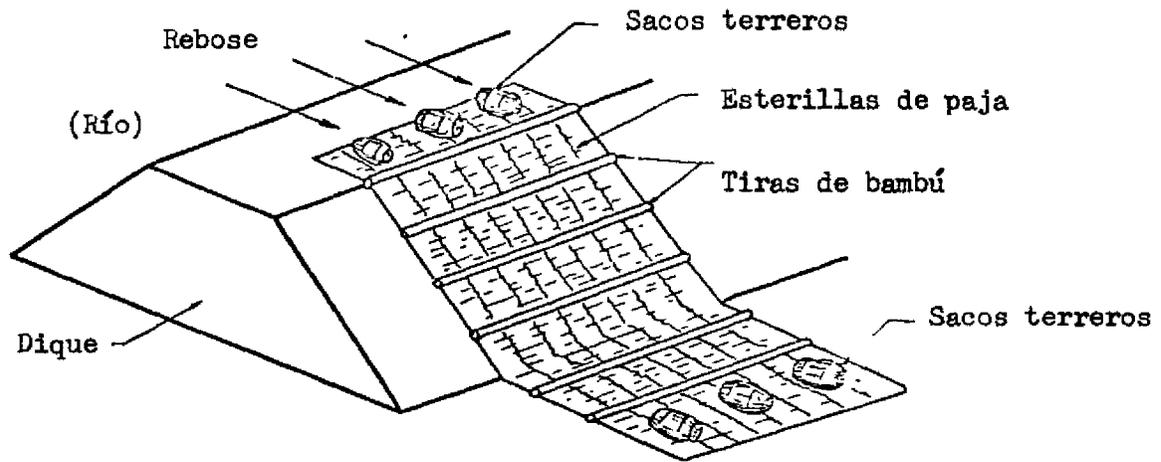
Figura 3.19 - Diagrama de protección de un dique de defensa con esterillas
