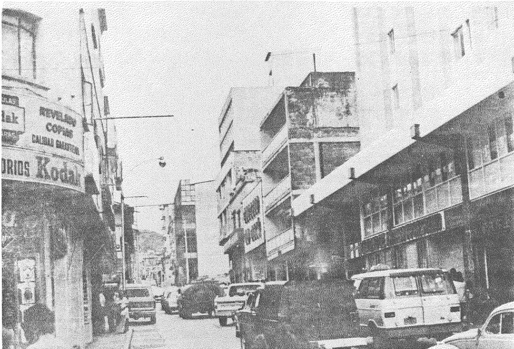
**Foto 26.- Edificaciones multifamiliares y comerciales de 4 y 5 pisos sin diseño sísmico localizadas en la Avenida 3, vulnerables al efecto de Colindancia por estar apareadas a edificaciones con diseño sísmico de 7 pisos.**
