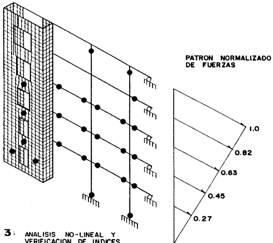
**FIGURA 3:** ANALISIS NO-LINEAL Y VERIFICACION DE INDICES DE DAÑO.
