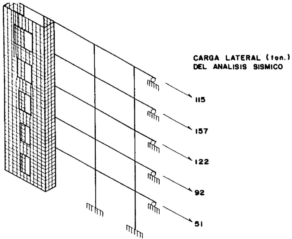
**FIGURA 2:** REVISION DE RIGIDEZ Y AGRIETAMIENTO EN MURO.
