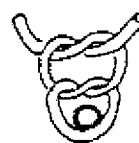
Figura 4d : segundo nudo en sentido contrario.
