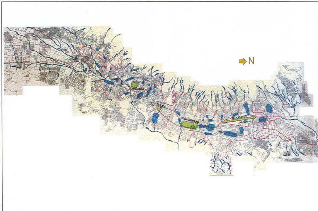
**Figura 2: Sitios de Quito afectados por inundaciones (áreas de color celeste) debidas a insuficiencias de la red de alcantarillado (colectores principales en color rojo).**
