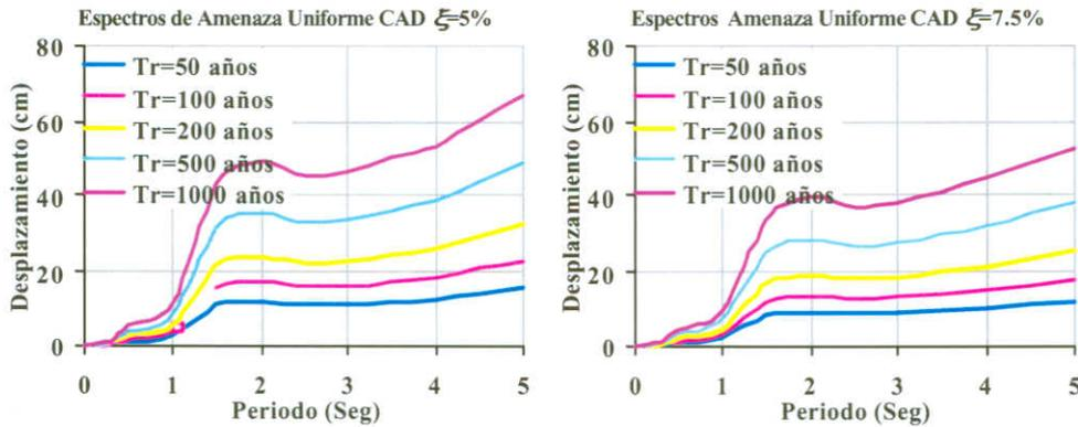
Figura 15: Espectros de amenaza uniforme de desplazamiento para diferentes periodos de retorno en el sitio CAD
