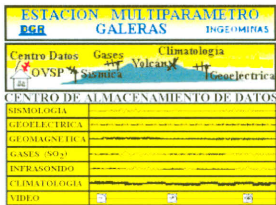
Figura 1. Diagrama que visualiza la filosofía de la Estación Multiparámetro, en el cual, un volcán activo es monitoreado en tiempo real, con adquisición simultánea de parámetros tales como: sismología, gases, electromagnetismo, video, climatología e infrasonido.
