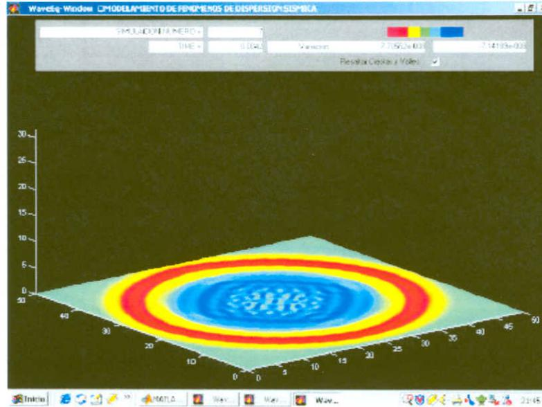
Fig 2. Para el instante  $T=198\text{ms}$  la onda ha superado la frontera y su refracción muestra una onda propagándose libre de atenuaciones
