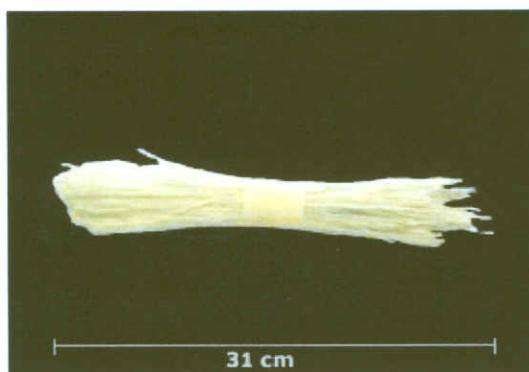
*Figura 10. Asbesto*
