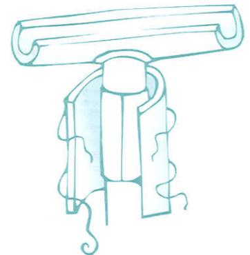
Las canales deben estar lo suficientemente inclinadas para permitir que el agua fluya libremente hacia la cisterna. Tampoco debe ser muy pendiente porque se sale el agua.
