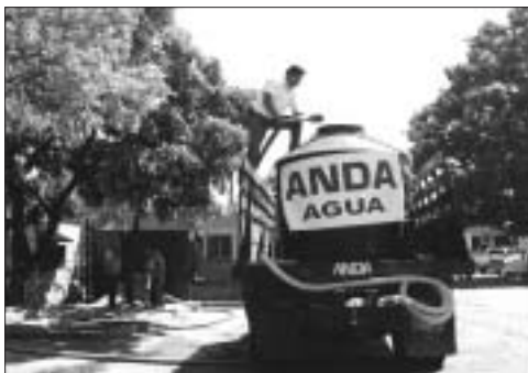
Adecuación de camión para distribución de agua debido a falta de disponibilidad de camiones cisterna durante los terremotos de El Salvador.
