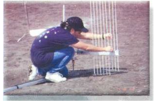
Equipo de monitoreo ha sido instalado en Islas de la Bahía para la documentación de los cambios y formas de sedimentación y cambios de elevación en los manglares, arrecifes y pastales.
